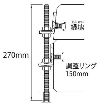
※注) 施工手順⑤のナットは、レベル調整が不要な場合でも必ずLUボルトに当たるまで上げてください。
