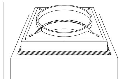
③ 鉄蓋を設置し、舗装面の計画高さと合っているか確認してください。
