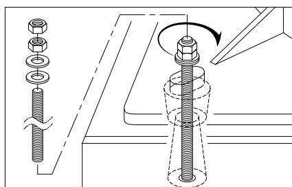
④ 全ネジ/ナット/ワッシャーを図のようにセットしてください。
