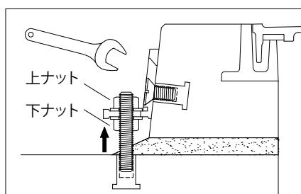
⑤下ナットをLUボルトに当たるまで上げ、⑥余分なモルタルを除去し、完全に硬化
