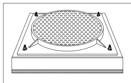
⑥ 余分なモルタルを除去し、完全に硬化すれば完了です。
