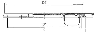
**ICN2K-12** 破壊荷重20kN以上
