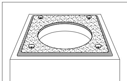
① 角型調整リング設置面に均一にモルタルを敷き、レベル調整をしてください。
