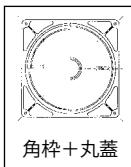
※鉄蓋は簡易防水型とし（電気・電話・情報・CATV）等の用途に応じたマークとなります。
